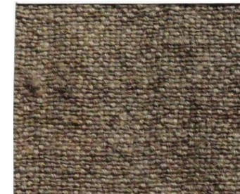
ȚESĂTURI FUNCȚIONALIZATE CU NANOPARTICULE DE AG SI CU
