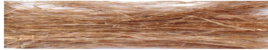
FIBRE TEHNICE DE IN SI CANEPA SEPARATE DIN TULPINI PRIN TEHNOLOGII NECONVENTIONALE
